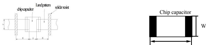
再流焊接时推荐设计的尺寸 (单位: mm)
