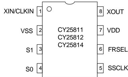
Table 1. Pin Definition - 8 Pin SOIC/TSSOP
