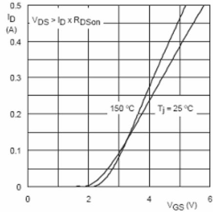
T<sub>j</sub> = 25 °C and 150 °C; V<sub>DS</sub> > I<sub>D</sub> × R<sub>DSon</sub>
