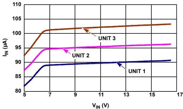
FIGURE 30.  $I_{IN}$  vs  $V_{IN}$ , 3 UNITS
