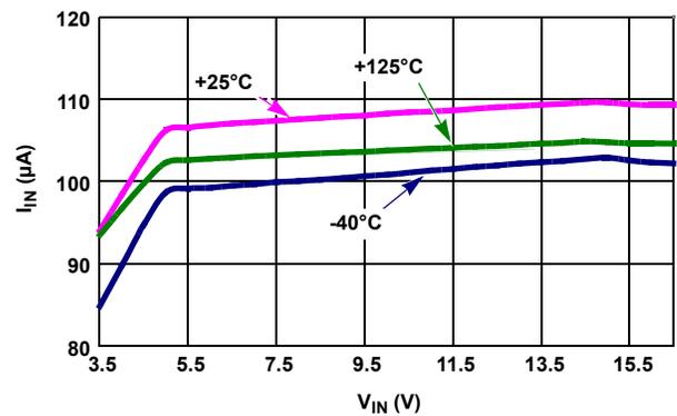
FIGURE 17.  $I_{IN}$  vs  $V_{IN}$ , 3 TEMPERATURES
