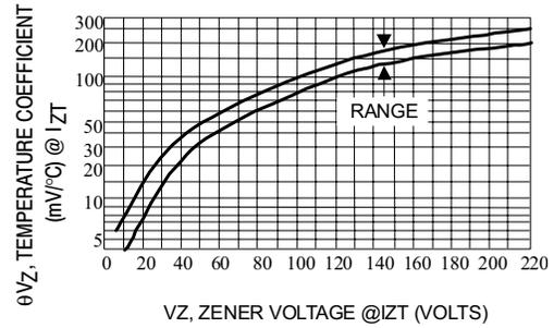
Fig. 2-TEMPERATURE COEFFICIENT-RANGE FOR UNITS 6 TO 51 VOLTS
