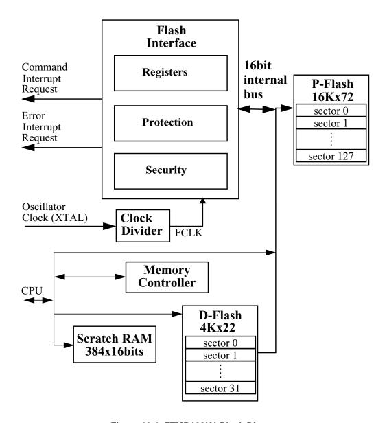
Figure 19-1. FTMR128K1 Block Diagram
