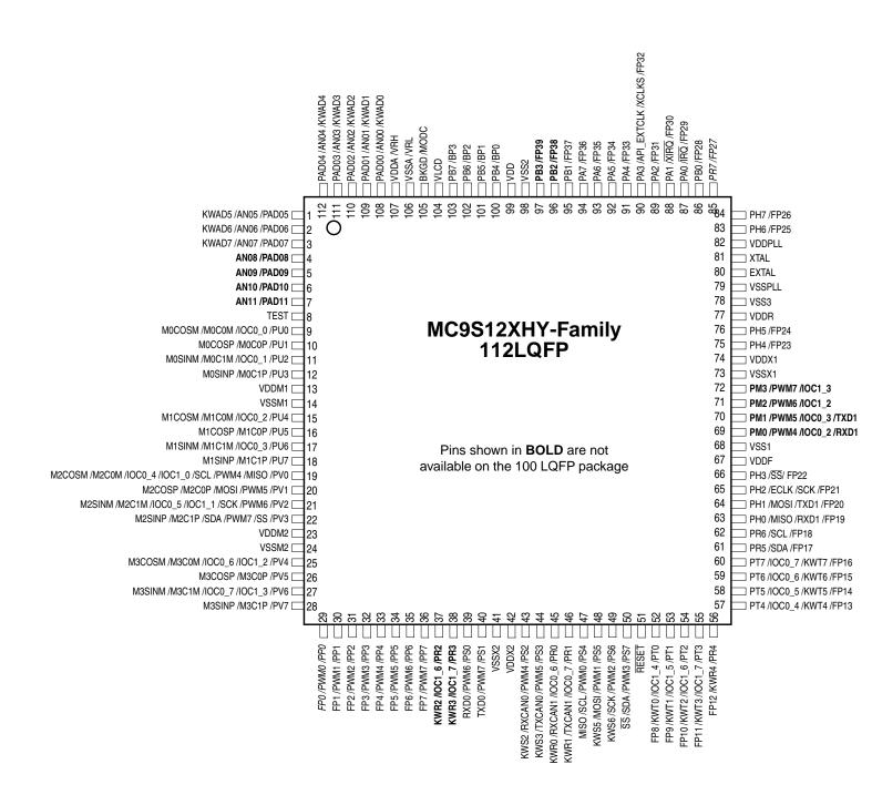
Figure 1-3. MC9S12XHY-Family 112 LQFP pinout
