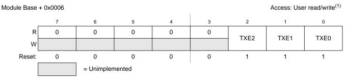
Figure 11-10. MSCAN Transmitter Flag Register (CANTFLG)
