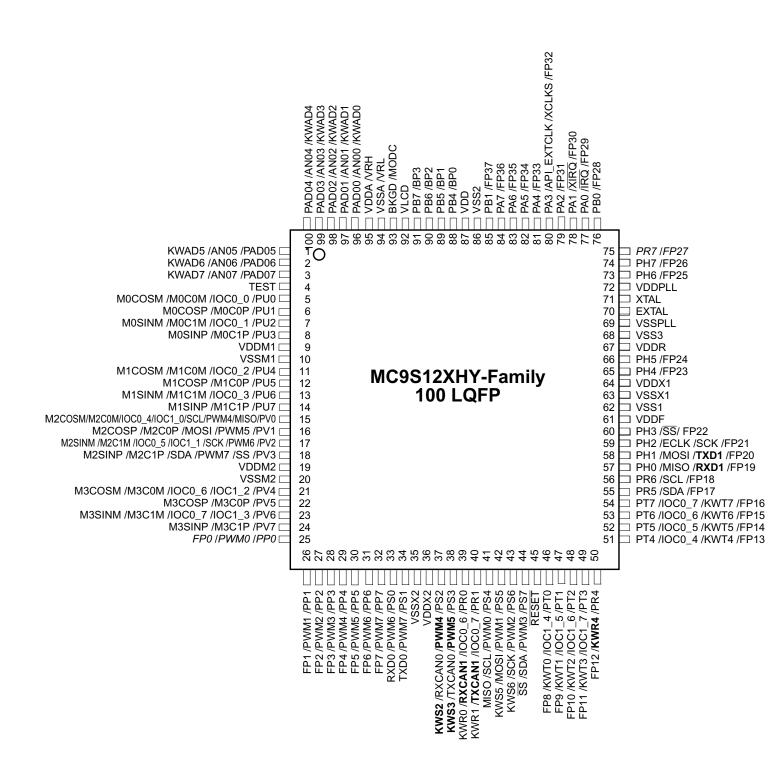
Figure 1-4. MC9S12XHY-Family 100LQFP pinout
