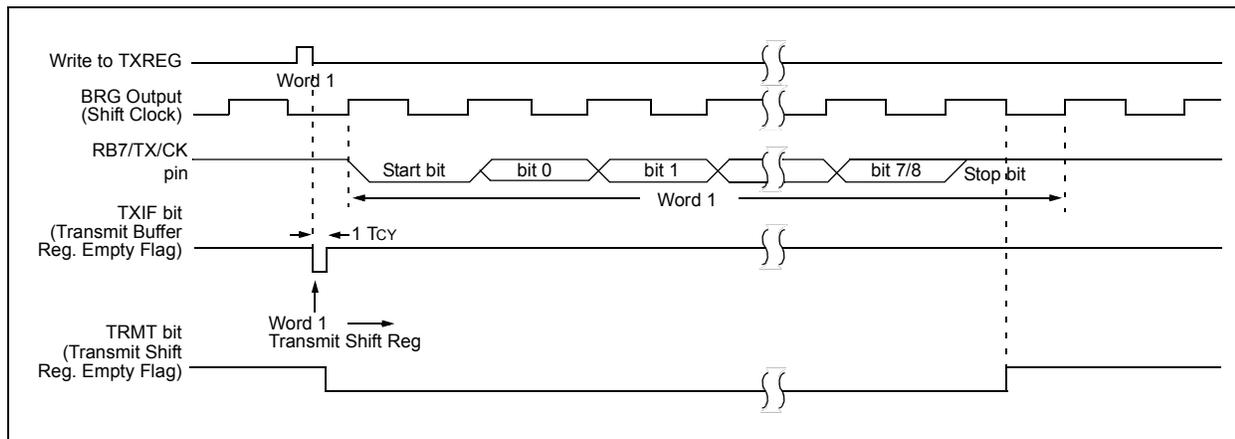
**FIGURE 15-4: ASYNCHRONOUS TRANSMISSION (BACK-TO-BACK)**
