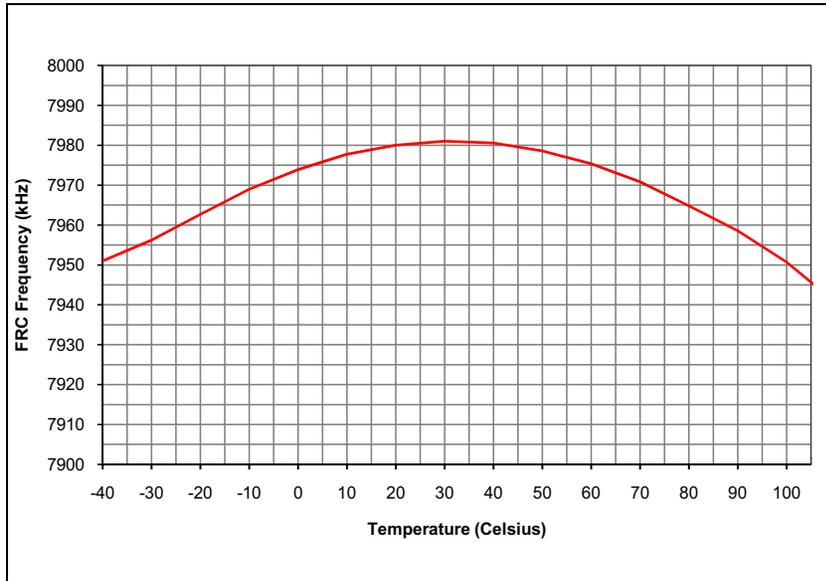
**FIGURE 30-7: TYPICAL LPRC FREQUENCY @ V<sub>DD</sub> = 3.3V**
