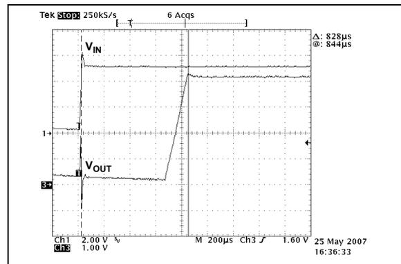
**FIGURE 2-23:**  $V_{AC}$  Start Delay ( $I_{OUT} = 1A$ ).
