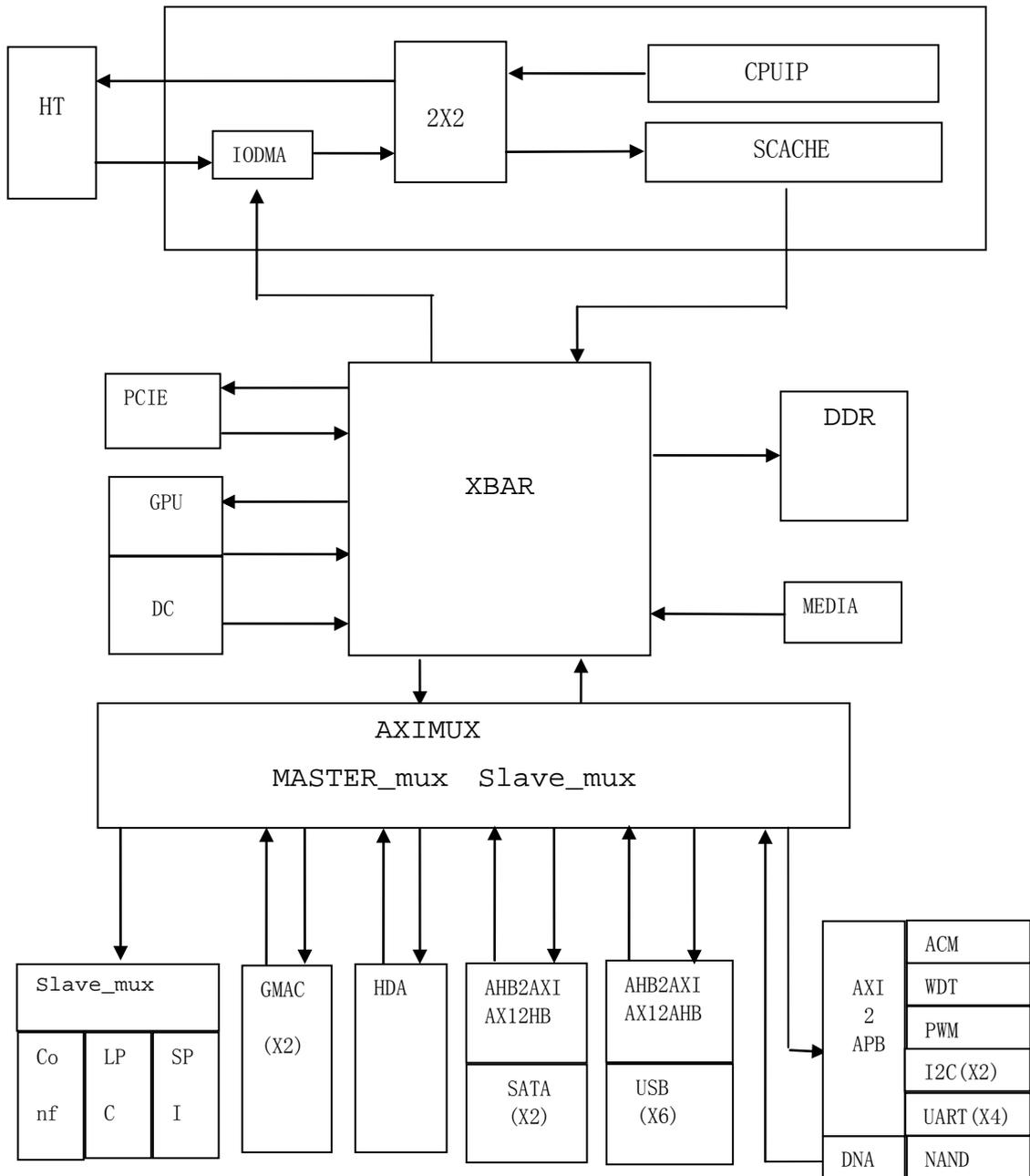
图 3 LS2H 内部的结构框图
