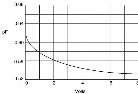
Diode Capacitance - pF *versus*
