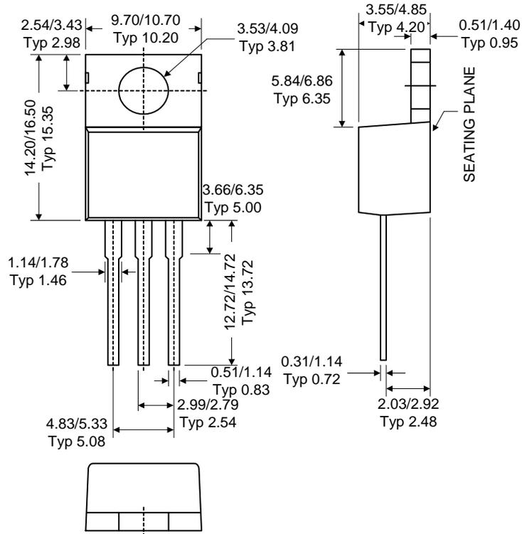
**1.5A LOW DROPOUT POSITIVE ADJUSTABLE OR
