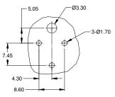
RECOMMENDED LAYOUT VIEW FROM COMPONENTS SIDE OF PCB
