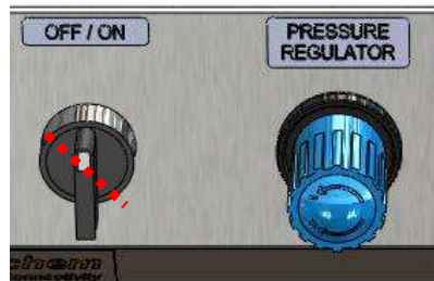
Hauptschalter auf AUS-Position
